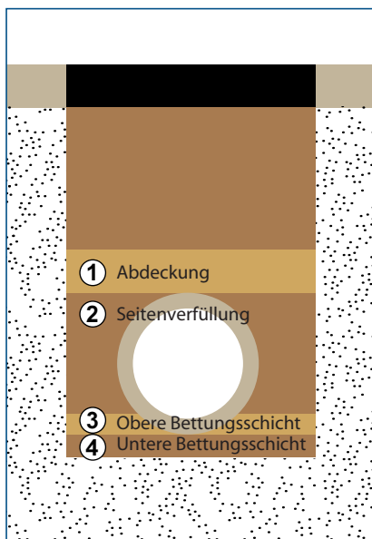
Abb. 1 Leitungszone nach DIN EN 1610
